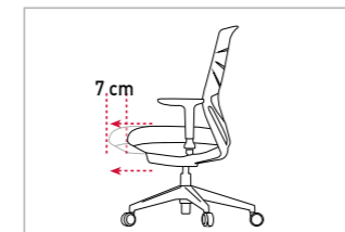
Bloqueo en 7 posiciones. Auto-retorno pulsando la maneta y levantándose del asiento.
